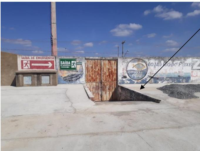
Ausência de guarda-corpo na saída de emergência.
